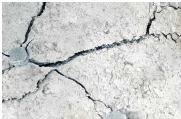
Abb. 9 Spalten durch Quelldruck
